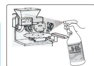
食品が接する場所、成形型、供給コンベアなどの使用前や洗浄後、十分に噴霧してください。
