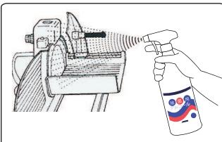
スライサー、ミキサー、ミートチョッパーなどの調理用機械は、使用前にすみずみまで噴霧してください。使用後は分解・洗浄後同様に噴霧してください。
