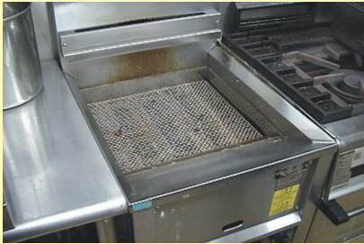
①フライヤーの油を抜きます。
